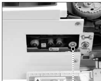
ハンドル ㉔ 出金搬送路の硬貨を取り出すときに矢印方向に回します。
